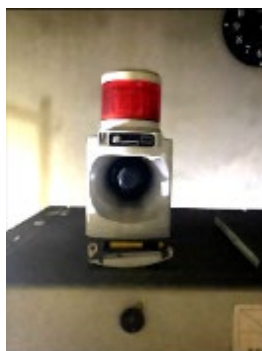
火災センサーランプ アラーム検知されると点灯するとともにアラート音が出る。
