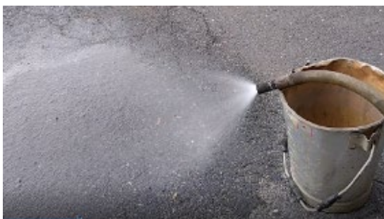
【ノズルからの放水テストの様子】 ※事故後火災現場から回収したもの。詰まり等は見られなかった。
